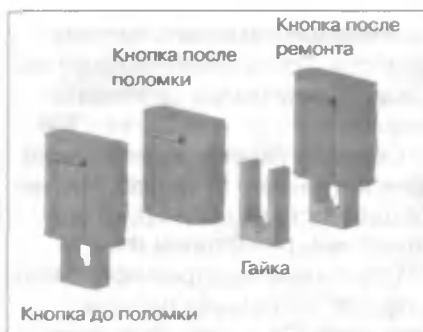
Рис. 4. Ремонт кнопки каретки
